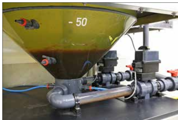
Abb. 3a/3b. P-Eliminationsmodul im Praxismaßstab, 500 l Reaktor- und ca. 50 l Sedimentationstrichtervolumen
