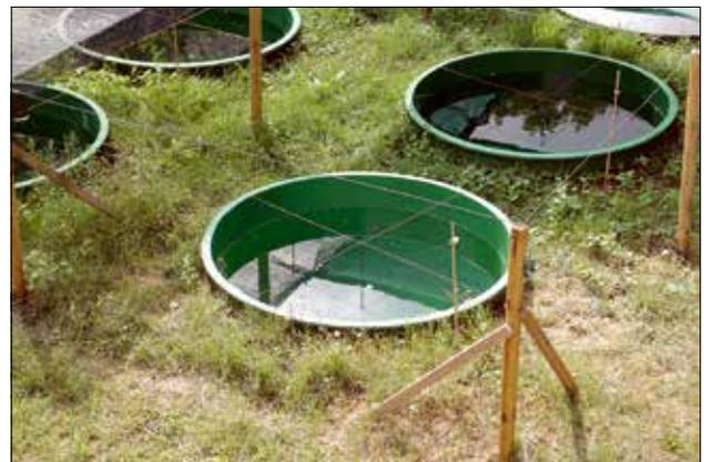
Abb 9 und 10: Verschiedene Werte werden in den Becken erhoben: Temperatur- und Lichtsensoren sitzen im Wasser sowie darüber, regelmäßig wird die Sauerstoffsättigung und über Metermaßstäbe indirekt die Verdunstung ermittelt, zudem die Besiedelung von Algen.
