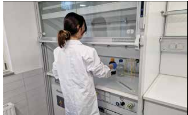
Abb. 3: Laborwerkbank mit Dunstabzug für mikrobiologische Untersuchungen im Wasserlabor.
