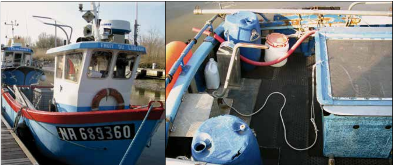
3: Boot für den Glasaalfang auf der Loire (links) mit zwei seitlich an Stangen angebrachten Schubnetzen und einem Fischhälterkasten mit Sieb als Deckel (rechts)
